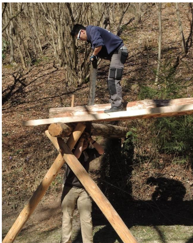
Figuur 22 Met twee personen zagen van een stam tot planken op een hoge 'bok'. Openluchtmuseum Stubbing, Oostenrijk.
